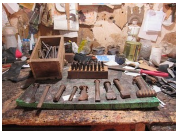
Foto 5: Ferros utilizados desde a época de seu avô, Venâncio Ferreira, para entalhar couro ou, como se dizia antigamente, ferros de “rebaixo”. Data: Agosto / 2019. Foto: Eder Melo.
